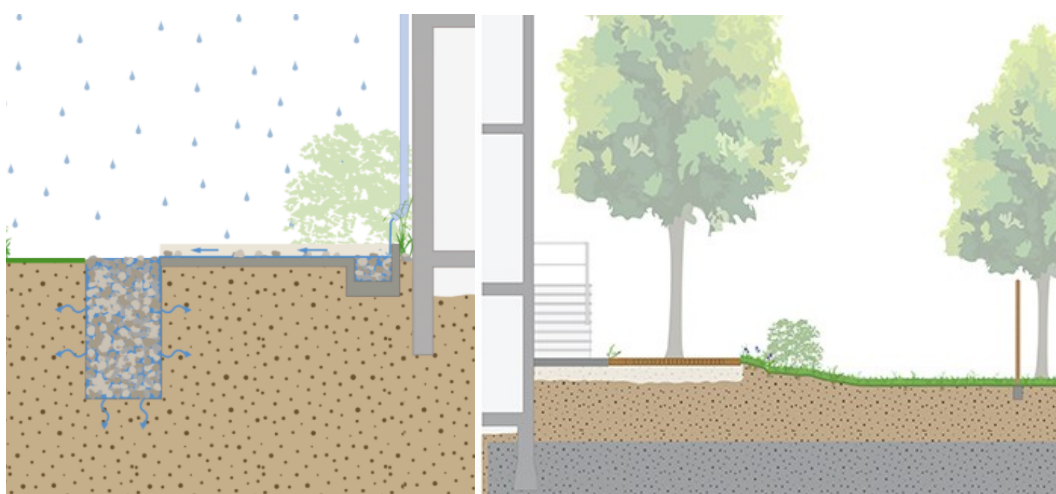
Figuur 9.2: Links een schematische doorsnede van een grindkoffer/strook (Atelier Groenblauw, z.d.-c.) en rechts van een reliëf (Amsterdam Rainproof, 2020-d)
